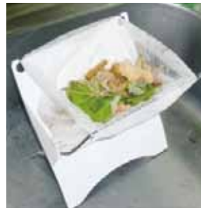
図7～8 水切り実験 10%の減量を確認
