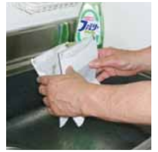
図7～8 水切り実験 10%の減量を確認
